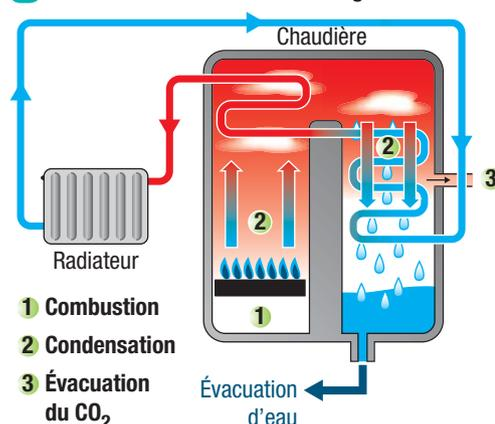
► La combustion du gaz naturel entraîne la formation de produits de combustion (vapeur d'eau et dioxyde de carbone). La chaudière à gaz à condensation récupère la chaleur contenue dans la vapeur d'eau pour la restituer au circuit de chauffage. Par rapport à une chaudière classique, elle permet une efficacité énergétique améliorée de 10 à 15 %.
