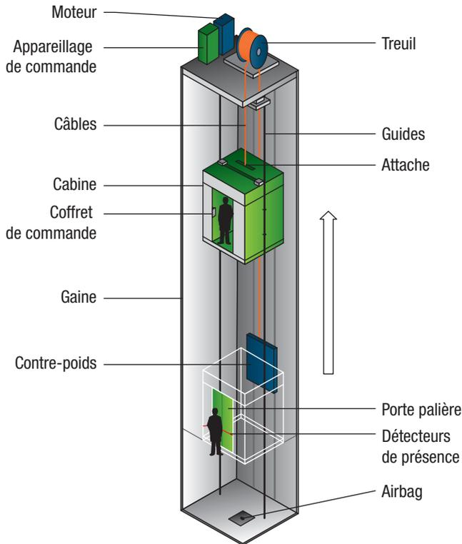
**b** Les blocs fonctionnels d'un ascenseur
