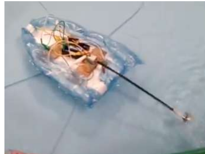
Piles : alimentation électrique d'un moteur qui fait tourner une hélice
